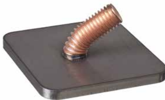
Abb.2: Zerstörende Schlagbiegeprobe. Eine vollflächige, lochlose und daher absolut dichte Schweißverbindung mit sehr hoher Festigkeit.
