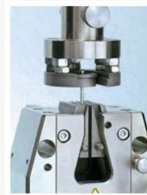
Test Nietdornbruchkraft Mandrel breaking test Essai de rupture de la tige
