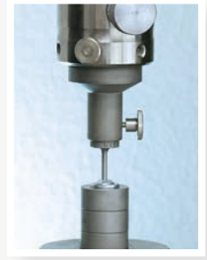
Test Restnietdornverriegelung Mandrel retaining test Essai de résistance au désassemblage de la tige
